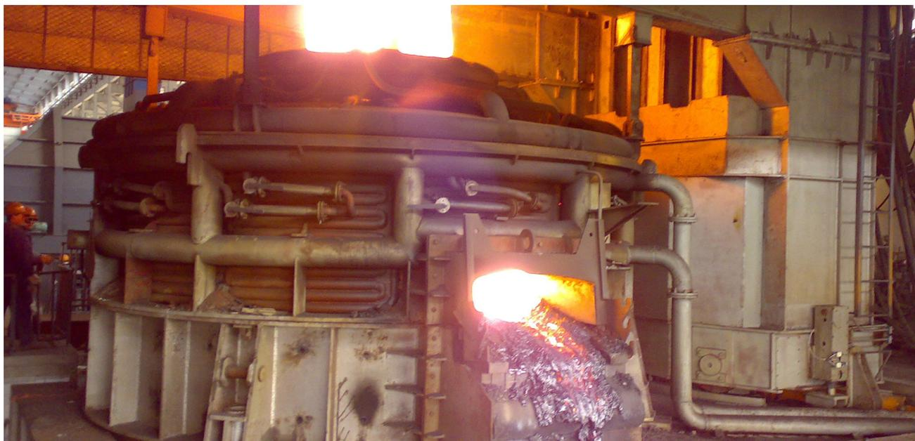
Figura 1.5 Horno de arco eléctrico.
