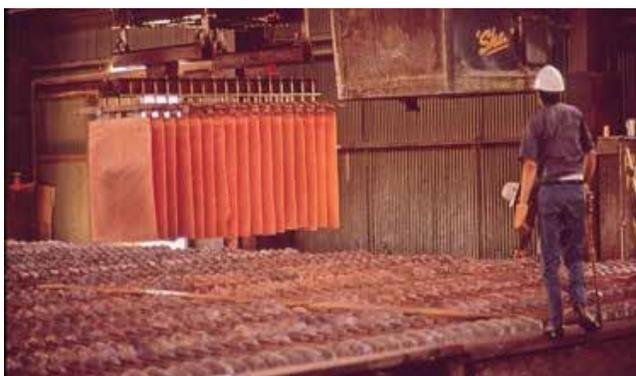
Figura 3.4 Catodos de Cobre por electro obtención.
