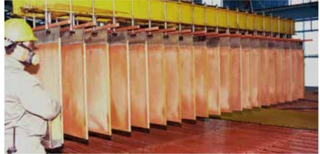
Figura 2.9 Electrorrefinación de Cobre.
