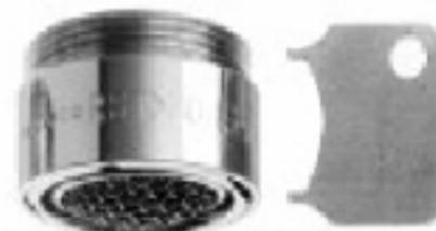
Los aireadores son unos elementos dispersores que se colocan en la boca de salida de agua de la llave y que mezclan aire con agua, consiguiendo romper el chorro de agua en muchas partículas minúsculas que salen a gran presión y mezcladas con aire.
