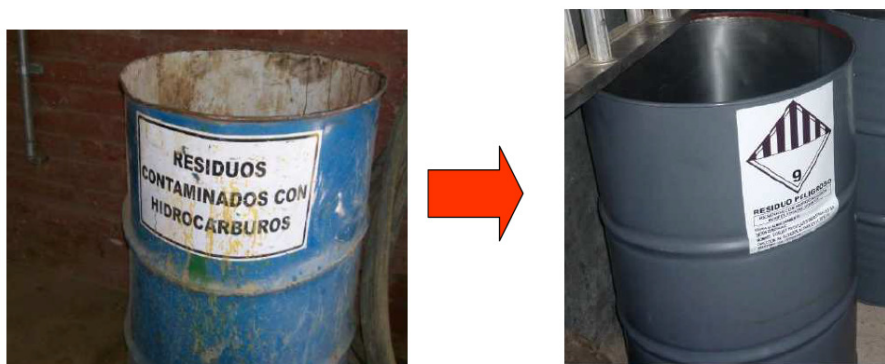
Figura 2-1 ejemplo de contenedor de residuos con señalética adecuada
