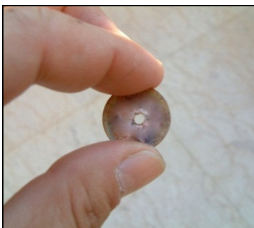
Figura 6: Restrictor de flujo de fabricación casera.
